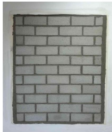
**Abb. 6:** Mauerwerk aus Porenbeton-Recyclingprodukten
