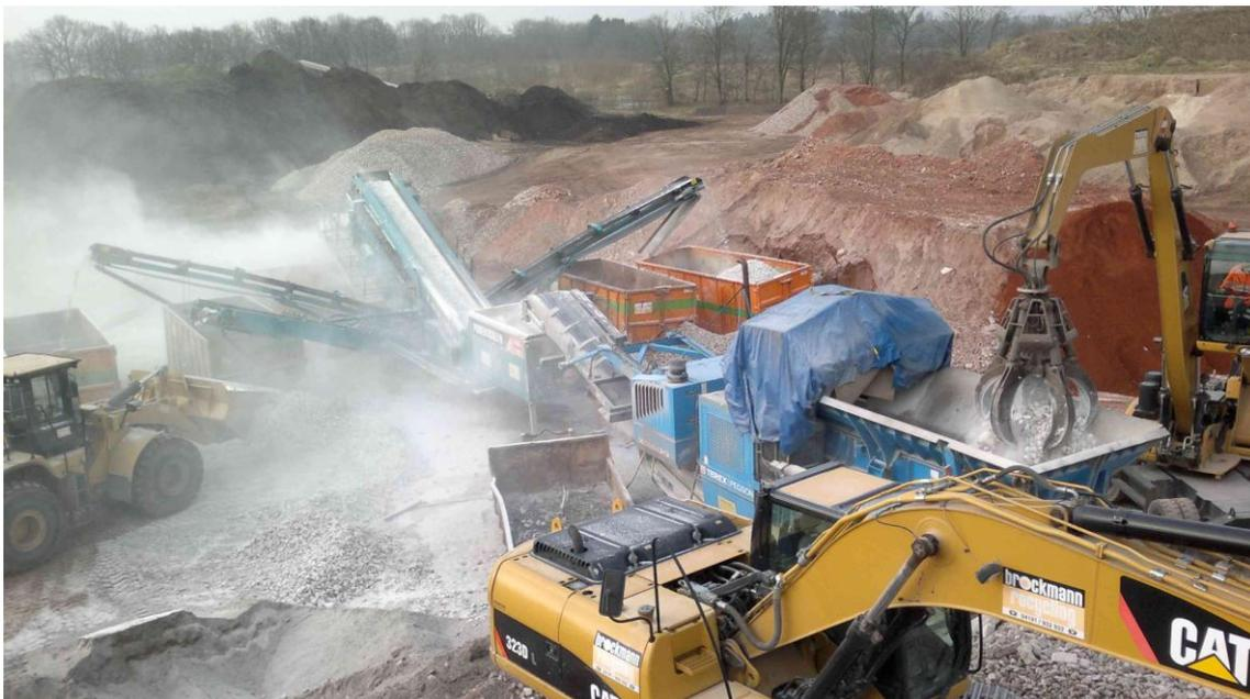
Abb. 1: Aufbereitung des Porenbetonrezyklats
