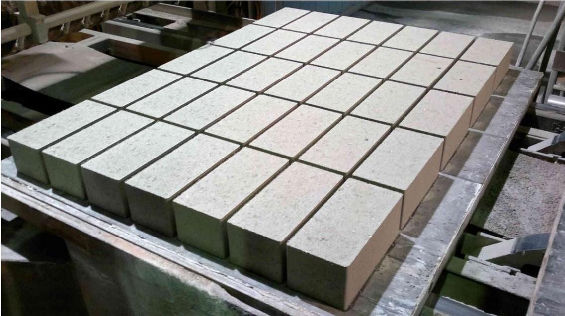
Abb. 5: Mauerstein-Rohlinge nach dem Verlassen der Verdichtungsanlage
