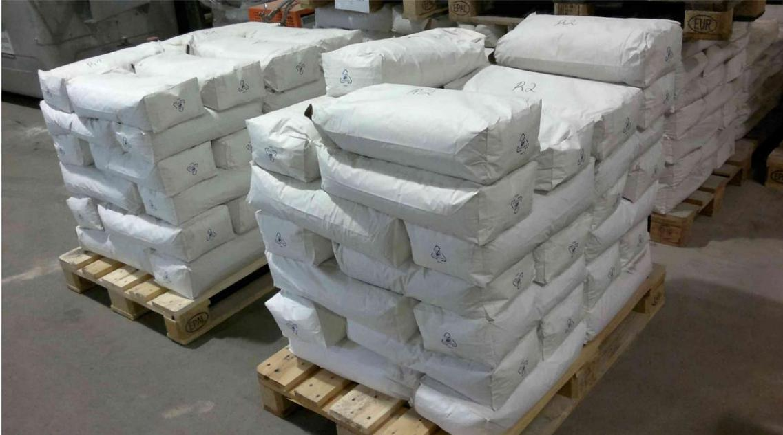
Abb. 3: Industriell gemischte Werk trocken-Mauermörtel
