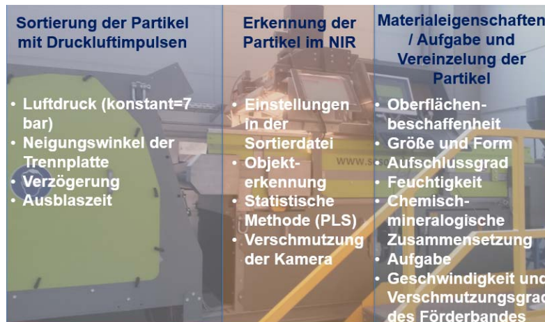
Abbildung 12: Übersicht der Einflussgrößen bei der NIR-Sortierung
