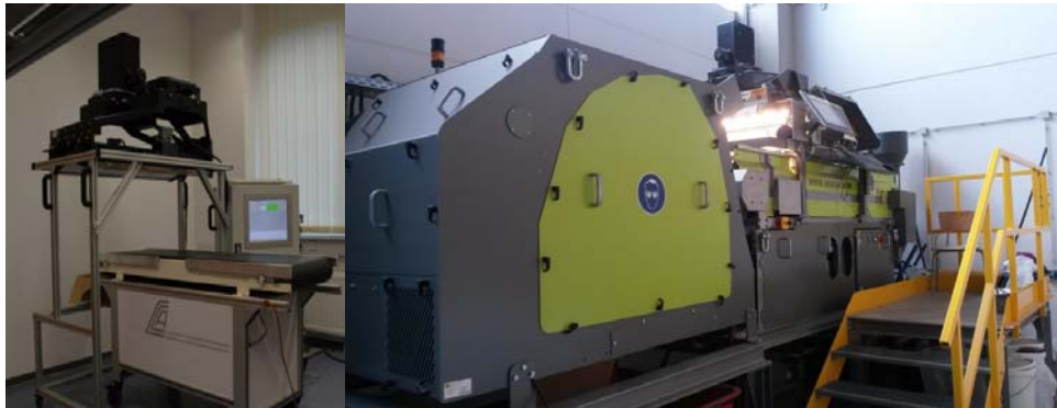
Abbildung 10: Laborspektrometer (links) und Prototyp einer Sortiermaschine für mineralische Bau- und Abbruchabfälle (rechts)
