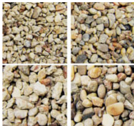
Die thermisch-mechanische Behandlung erzeugt kiesähnliche Körnungen: 2/4 und 4/8 mm vor (links) und nach Behandlung
