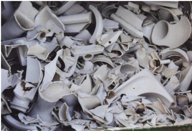
Sanitärkeramikscherben entstanden aus Hohlkörper mit geringen Wandstärken [12]
