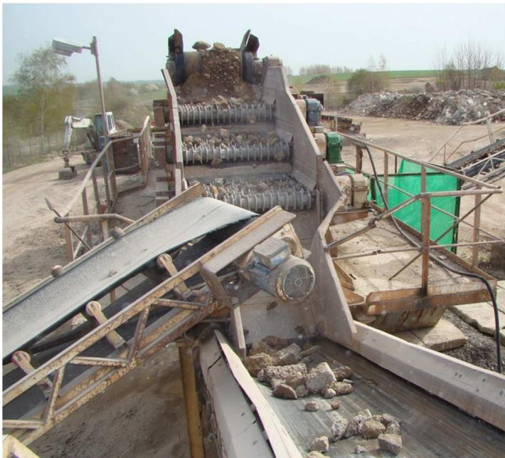
Bild 4- 26: Diskscheider in einer stationären Recyclinganlage
