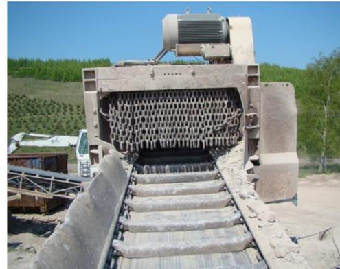
Bild 4- 15: Prinzipskizze und Aufgabeöffnung eines Schlagwalzenbrechers
