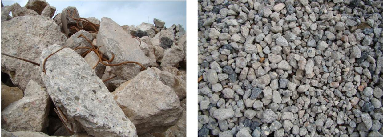
Bild 4- 16: Aufgabematerial Betonbruch und daraus hergestellter RC-Baustoff 0/45 mm
