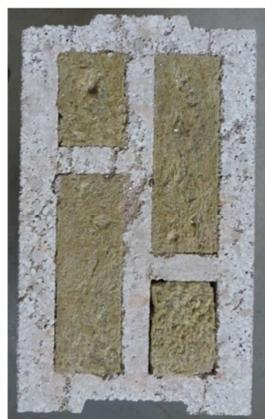
Ziegel bzw. Leichtbetonsteine mit ausgeprägtem Lochbild [10]
