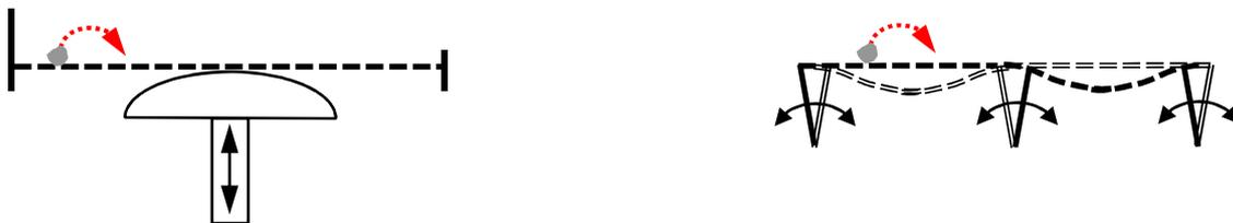
Bild 4- 29: Schematische Darstellung der Siebboden- und Siebgutbewegung bei Stößelsieb und Spannwellensieb (in Anlehnung [14])
