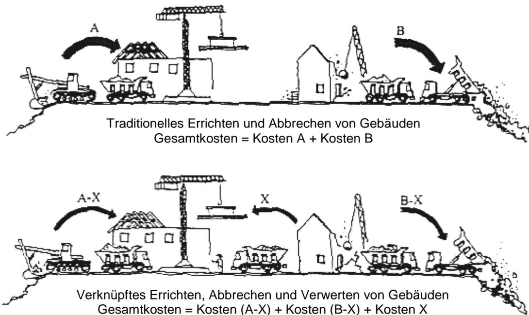
Bild 1-3: Gegenüberstellung der Bauwerkerrichtung ohne und mit Verwertung von RC-Baustoffen (entnommen aus [11])
